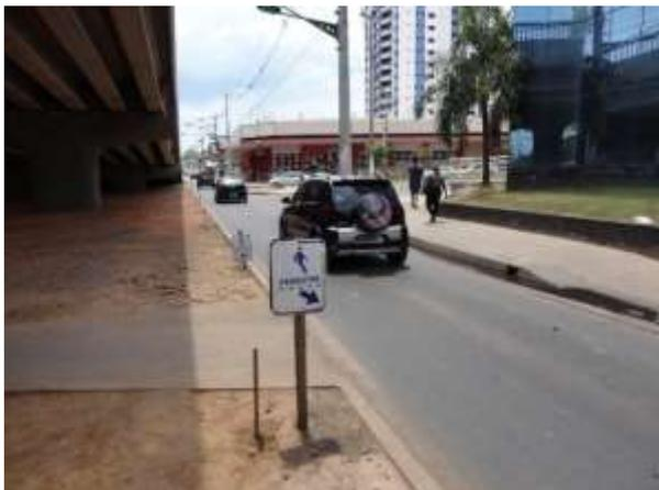
**Figura 05 - Faixa de pedestre parcialmente apagada e com sinalização vertical inadequada**
